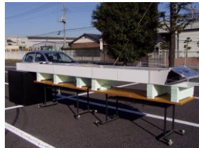
写真-2 光ダクト長さ 4800mm
