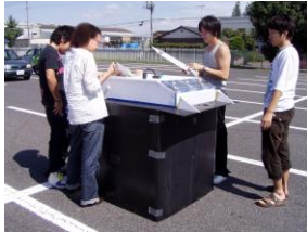
写真-1 光ダクト長さ 900mm
